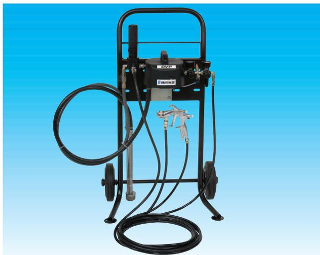
DVP-C-FLG5: Pompa standard su carrello, gruppo bypass/filtro per liquidi, doppio regolatore dell'aria, tubo per aria e liquidi lungo 7,5 m, bacchetta di aspirazione flessibile e pistola a spruzzo tradizionale FLG5†
