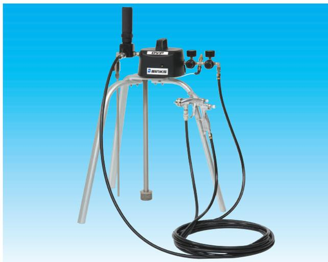
DVP-T-FLG5: Pompa standard su treppiede, gruppo bypass/filtro per fluidi, doppio regolatore dell'aria, tubo per aria e liquidi lungo 7,5 m, tubo di raccolta e filtro in acciaio inossidabile e pistola a spruzzo tradizionale FLG5†
